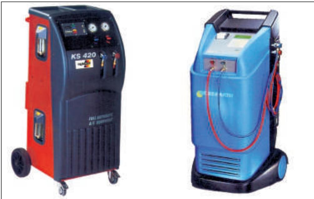
Σχήμα 6.14: Συσκευές πλήρωσης και ελέγχου του ψυκτικού κυκλώματος.
