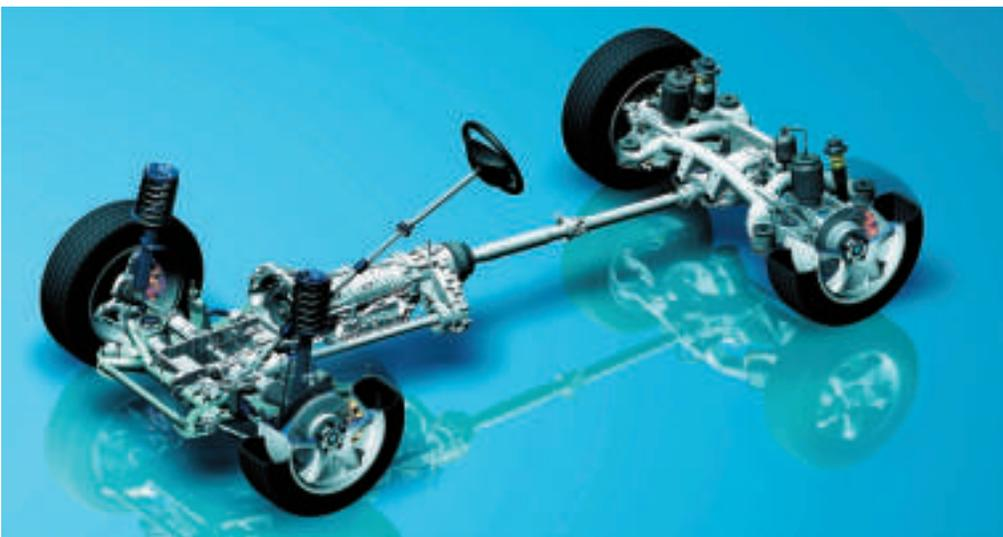
*Σχήμα 1.72: Το σύστημα μετάδοσης ενός τετρακίνητου οχήματος.*
