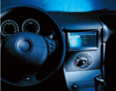
*Σχήμα 5.4: Ταμπλό με οθόνη αφής για τον έλεγχο και τις ρυθμίσεις.*
