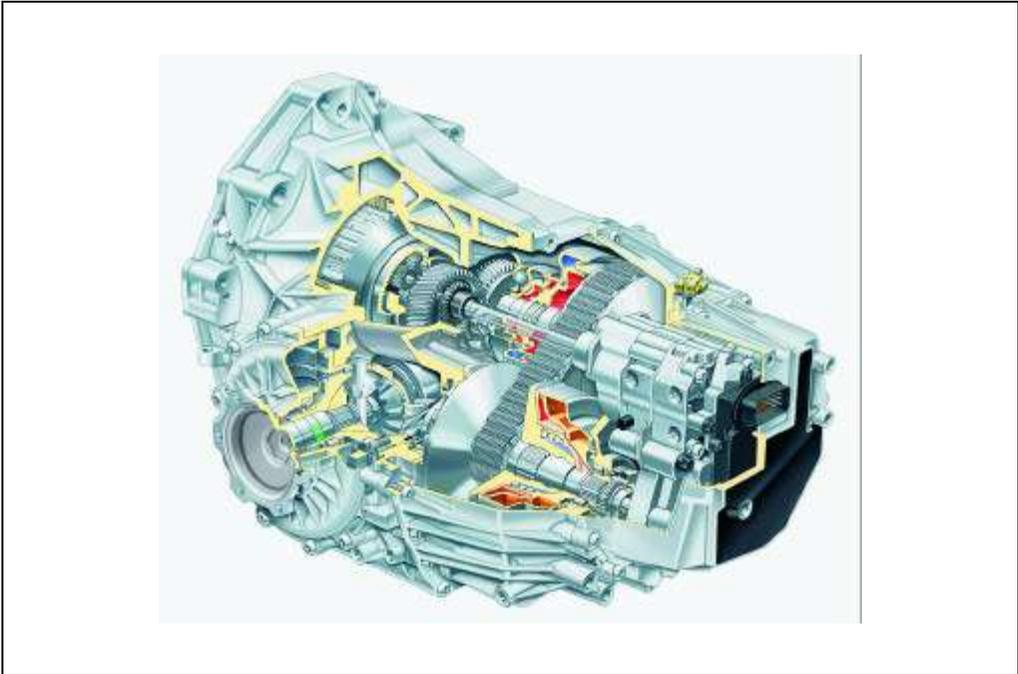
*Σχήμα 1.25: Κιβώτιο CVT σε τομή.*
