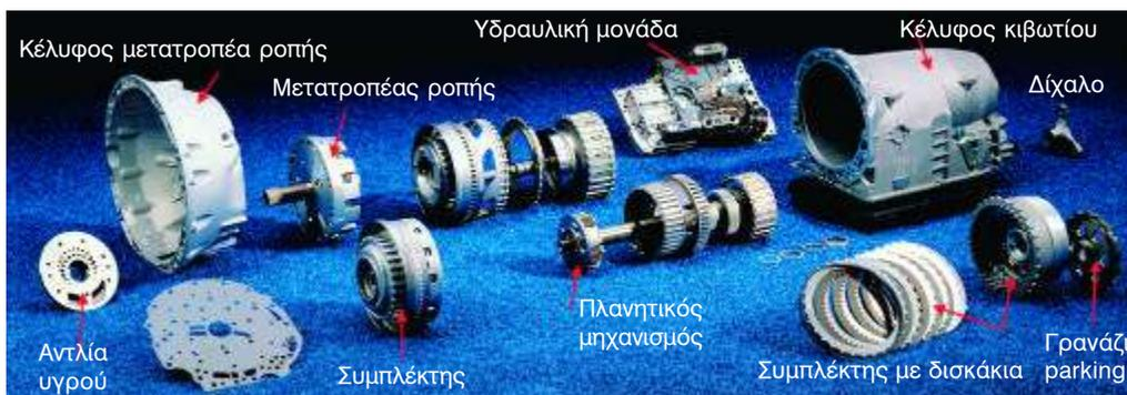
Σχήμα 1.36: Εξαρτήματα αυτόματου κιβωτίου ταχυτήτων.
